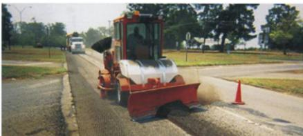
Используйте отвал для очистки дорожного полотна вслед за работой фрезерной машины, или после работ по вскрытию и укладке дорожного полотна.
